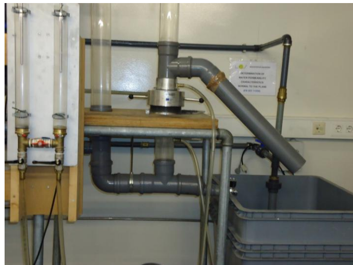
Figura 3.35 – Sistema de descarga.
