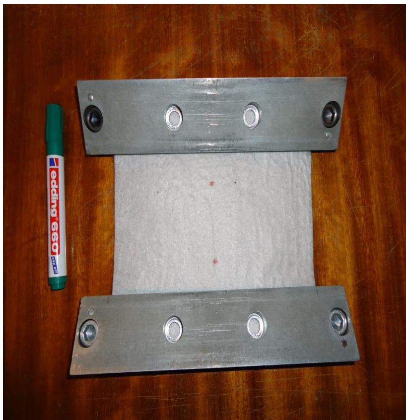
Figura 3.13 - Preparação do provete para o ensaio de tracção e disposição nas cunhas.
