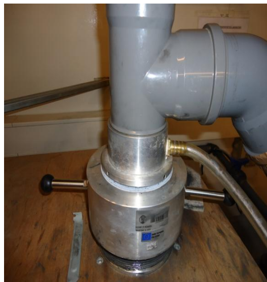
a) b) Figura 3.30 - Tubos piezométricos: a) Montante do provete; b) Jusante do provete.
