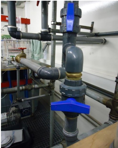
Figura 3.34 - Válvulas para ajuste do escoamento: a) de grandes dimensões; b) de pequenas dimensões.
