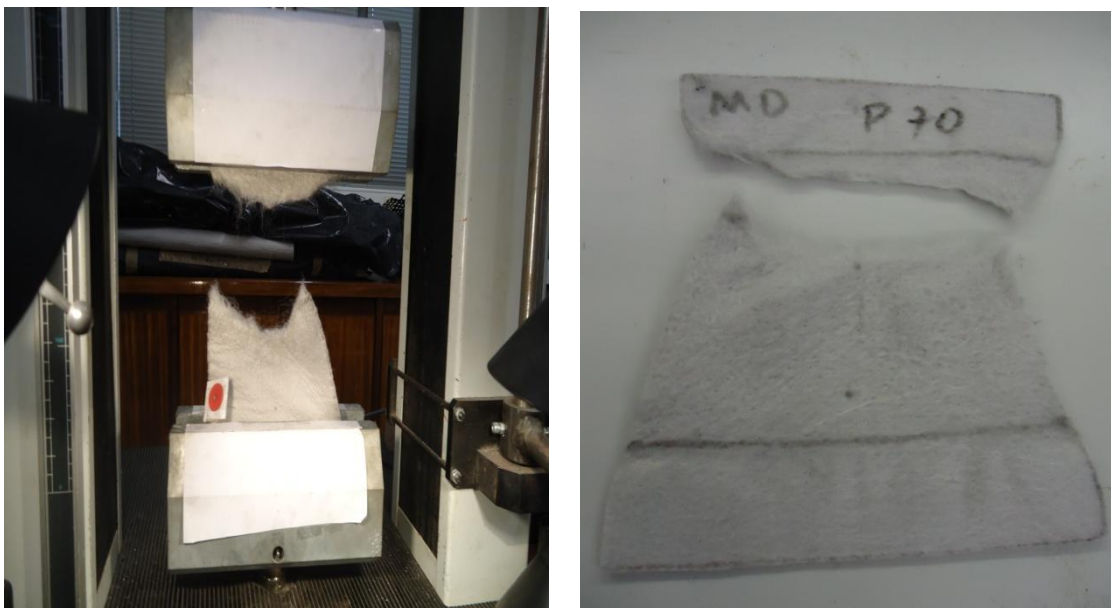
Figura 3.14 - Aspecto de um provete do geotêxtil P70 após a realização do ensaio de tracção.
