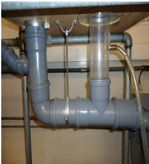
Figura 3.26 - Partes transparentes do circuito: a) Inferior; b) Superior.
