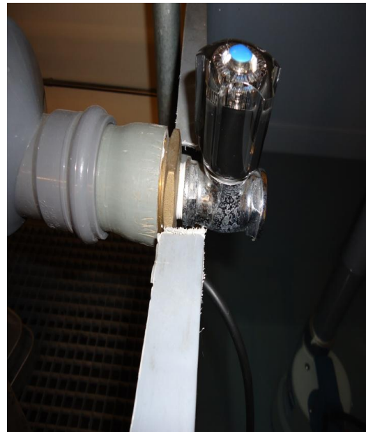
Figura 3.34 - Válvulas para ajuste do escoamento: a) de grandes dimensões; b) de pequenas dimensões.
