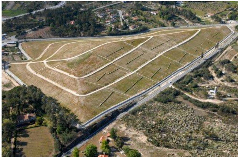
Figura 2.11 - Aplicações de geotexteis na protecção.
