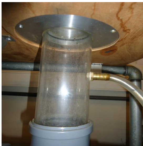
a) b) Figura 3.30 - Tubos piezométricos: a) Montante do provete; b) Jusante do provete.
