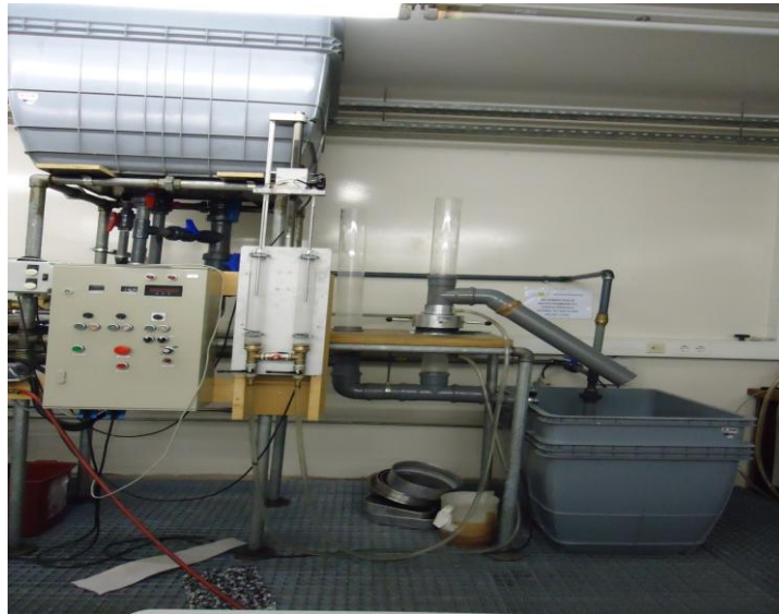
Figura 3.24 - Equipamento de ensaio da permeabilidade normal ao plano do material: vista geral, com os reservatórios superior e inferior.
