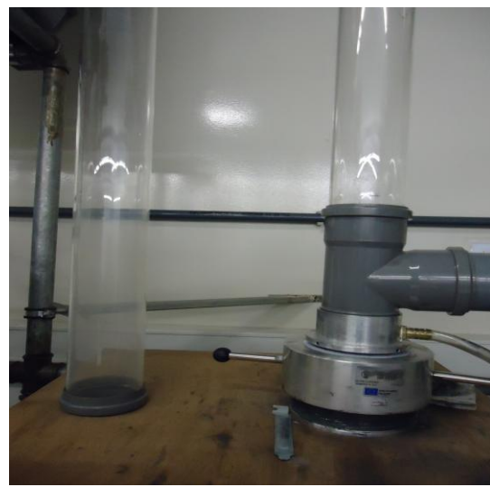
Figura 3.26 - Partes transparentes do circuito: a) Inferior; b) Superior.
