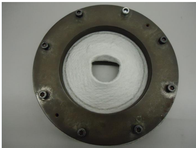
Figura 3.5 – Aspecto do geotêxtil após a realização do ensaio punçoamento estático.
