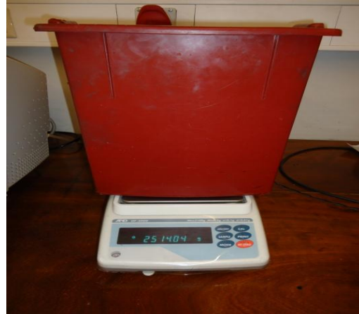
Figura 3.39 – Quantificação da água passada através do provete: a) Recolha da água; b) Pesagem da água.
