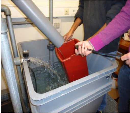
Figura 3.39 – Quantificação da água passada através do provete: a) Recolha da água; b) Pesagem da água.
